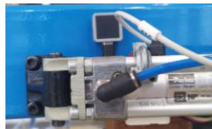
Exemple d'intégration sur empileur/dépilleur Multitec
