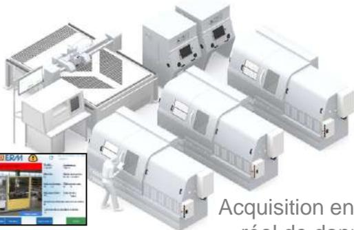
Acquisition en temps réel de données machines en cours de production
