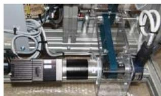
Motorisation Brushless, courroie crantée et codeur incrémental
