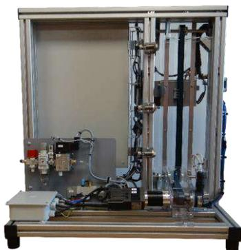
Partie opérative à technologie électropneumatique
