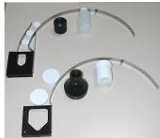
Magasin de distribution bouchons avec tête de vissage bouchons et contenants format "Flacon"
