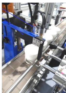
Contrôle par détecteur de présence bouchon et fourche de contrôle vissage
