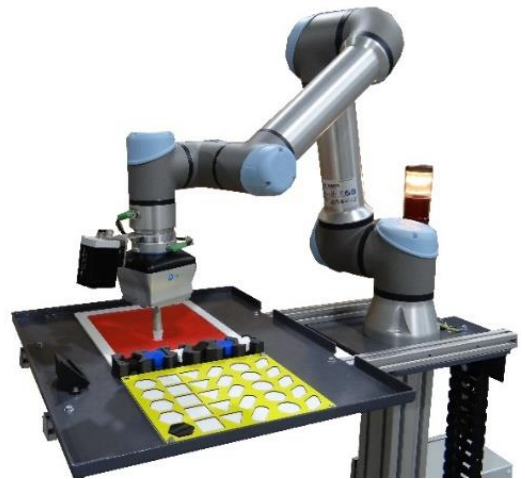
Station Cobot & Vision UR5 eSeries avec pièces pour projet de dévissage 2D et pick-and-place
