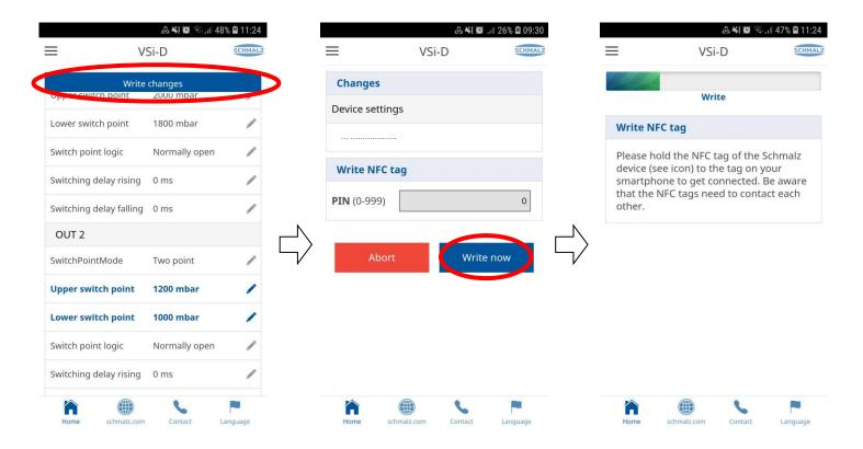
Si lors de l'écriture des paramètres dans le TAG NFC le capteur n'était pas alimenté : l'avancée de la tâche « Verify » ne se termine pas, mais l'écriture du TAG est bien effectuée et le contact du smartphone avec le capteur n'est plus nécessaire. Il faut terminer l'action en alimentant le capteur, puis en refaisant un test de lecture du TAG NFC pour vérifier si les nouveaux paramètres ont bien été pris en compte.
