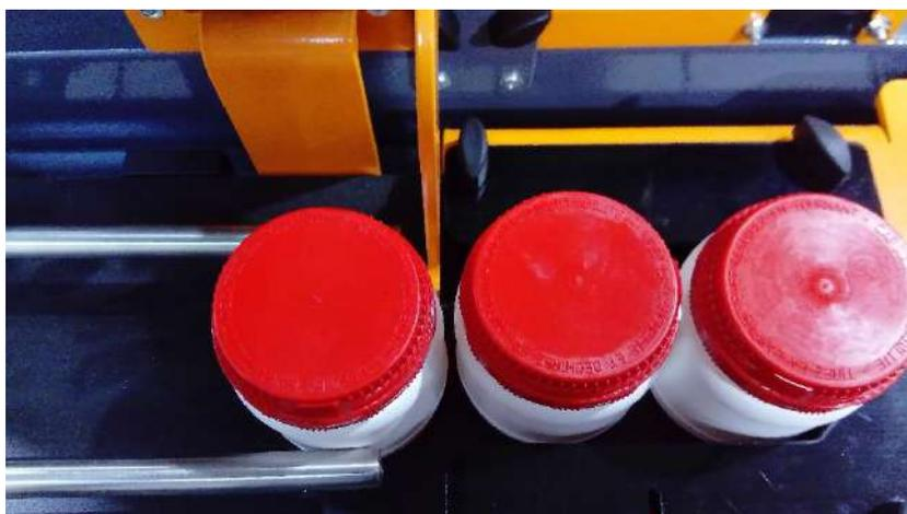
Réglage des rives du convoyeur
