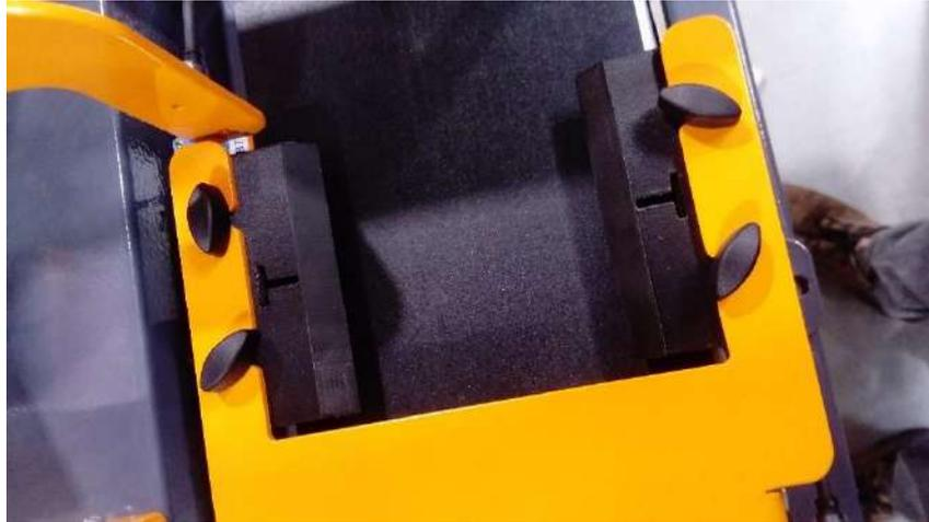
Monter le taquet Palette en le reculant au maximum.
