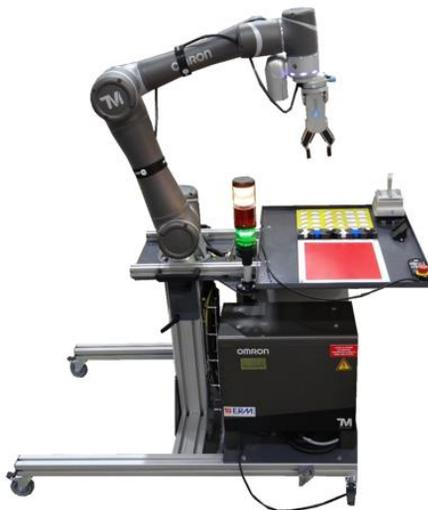
ON00: Station Cobot & Vision « Omron TM5 » avec châssis réglable en hauteur et plateau amovible
