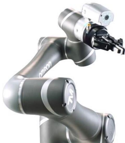
**Option UR14: Caméra 3D en bout de bras robot pour dévissage 3D**
