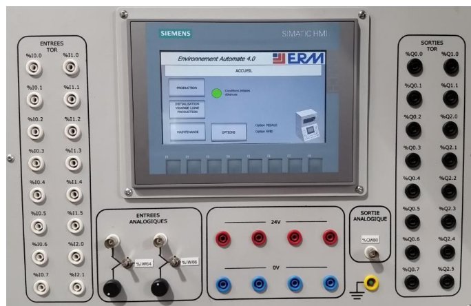
Interfaz de conexión con clavijas de doble hueco (conectores banana) y conectores BNC. Y pantalla táctil opcional.
