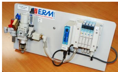
Conjunto de válvula neumática con isla neumática de comunicación IO-Link y presostato
