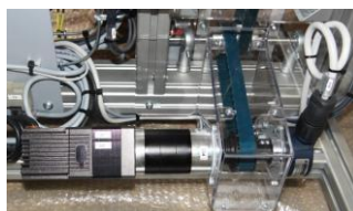
Motorización sin escobillas, correa dentada y codificador incremental
