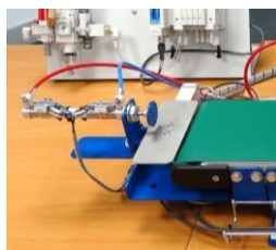
Estación de pesaje integrada en la parte operativa
