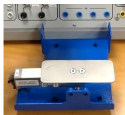
Galga extensométrica en la estación de pesaje
