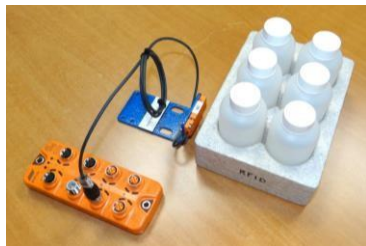
Maestro IO-Linky cabezal de lectura- escritura RFID
