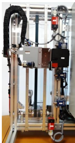
Parte operativa con interruptores de seguridad y enclavamiento
