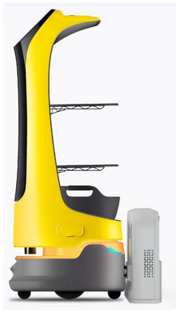
Punto de recarga automática
