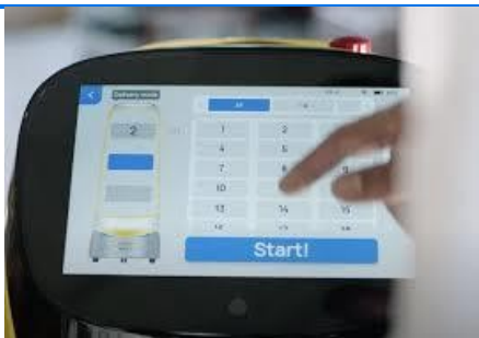
Panel táctil para interactuar con el robot y planificar las tareas a realizar
