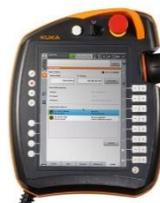
Pupitre tactile de commande du robot SmartPad
